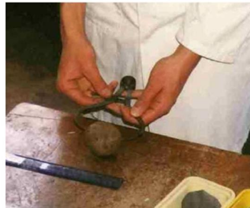
Medindo o diâmetro da bola de barro antes de soltá-la, usando compassos de espessura e uma régua (Fotografias: Peter Kennett)
