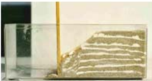
Estágios sucessivos da formação de uma falha normal – e um vale em rifte ( rift-valley ).
