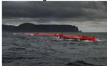
O conversor de energia por ondas Pelamis sendo testado no European Marine Energy Test Centre (EMEC)
