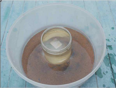
O modelo construído da 'curva contínua do rio' com uma camada de areia e minério denso
