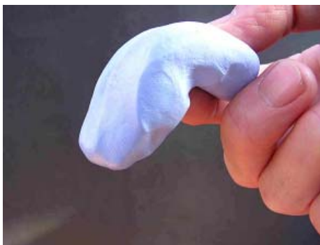
Deformação plástica sob seu próprio peso
