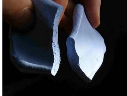
Deformação frágil quando quebrada
