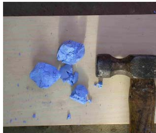
Deformação frágil quando a massa é atingida por um martelo. (Fotos: Peter Kennett)
