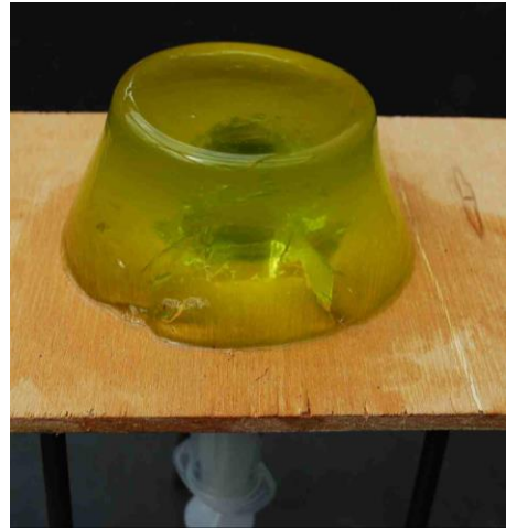
"Caldeira de subsidência", depois de puxar o êmbolo duas ou três vezes. Uma fratura radial também pode ser vista, produzida quando o êmbolo for empurrado.
