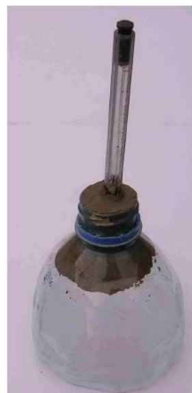
Funil caseiro usando a parte superior de uma garrafa, um tubo de uma caneta esferográfica e um pouco de argila (Fotografias: P. Kennett)
