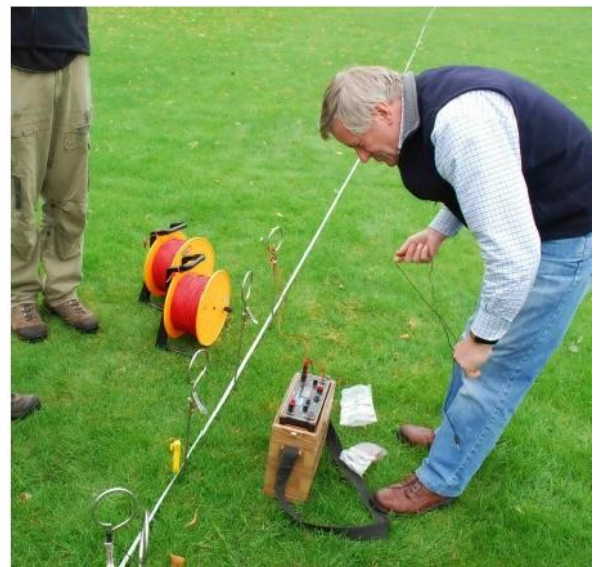
Os métodos elétricos são usados em campo – neste caso, para localizar um tambor de aço enterrado (Fotografias por Peter Kennett)
