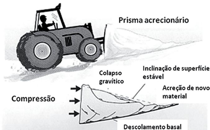
Figura 4. Desenho esquemático simplificando a teoria da forma crítica do prisma (adaptado de Fossen 2010). A compressão provoca a deformação interna até que o prisma adquira a inclinação crítica ou estável da superfície. Se a compressão continuar regista-se o colapso gravítico mantendo-se a mesma inclinação da superfície do prisma
