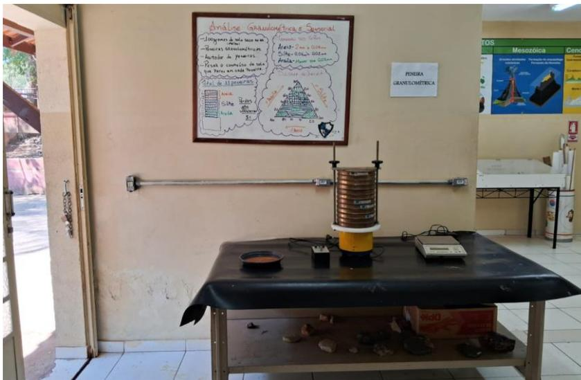
**Foto 5: Conjunto de peneiras granulométricas juntamente com o agitador e mesa de suporte, balança semianalítica e, quadro de análise granulométrica e sensorial. Fonte: autores, laboratório de geociências**
