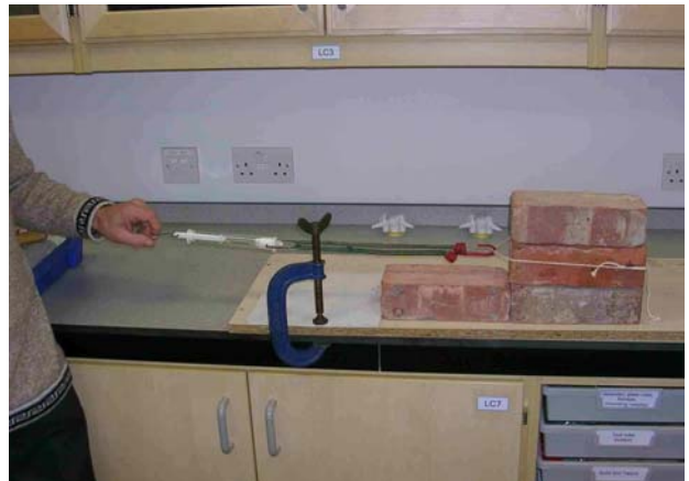
O 'terremoto' com tijolos em ação – b) Usando um metro de Newton para quantificar a força envolvida. O tijolo da frente é impedido de se mover por uma tábua, presa a bancada por uma morça.
