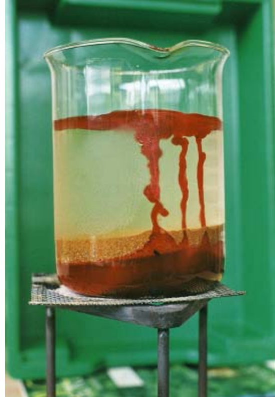
O vulcão de cera em ação – neste exemplo, uma superfície de “fluxo de lava” é alimentada por três tubos de cera, com “intrusões” crescendo próximas às suas bases – mas todas as erupções são diferentes. (Foto: Peter Kennett)
