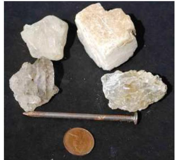
Dureza: fluorita, calcita, gipsita e quartzo com um prego de aço e uma moeda de cobre
