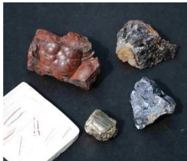
Traço: hematita, esfalerita, galena e pirita com uma placa de traço.
