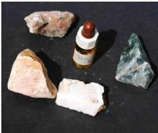
Teste de ácido: gipsita, fluorita, calcita, bário e um frasco conta-gotas de ácido clorídrico diluído.
