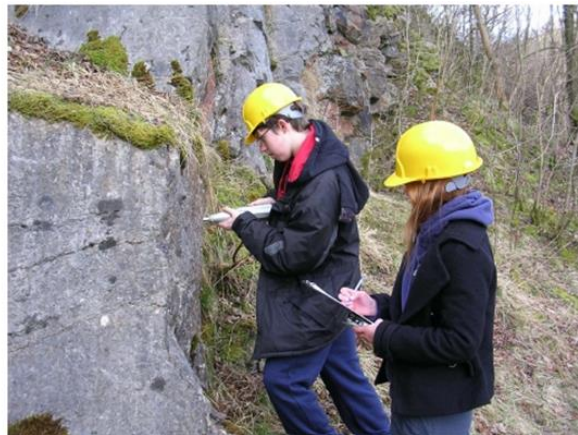
Estudantes utilizando um Martelo de Schmidt para medir a resistência de um calcário, como parte de um exercício de planejamento de túnel.
