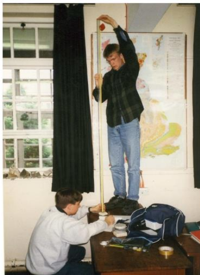
Estudantes testando o recuo da esfera metálica oriunda de uma amostra de rocha (utilizando um tubo de plástico de 2 m de comprimento).
