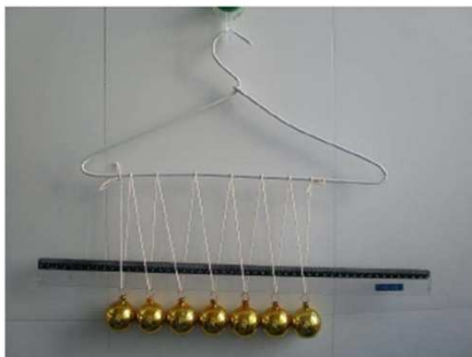
Alinhando as bolas em um modelo de transmissão de ondas no “estilo de Natal” com o auxílio de uma régua.
