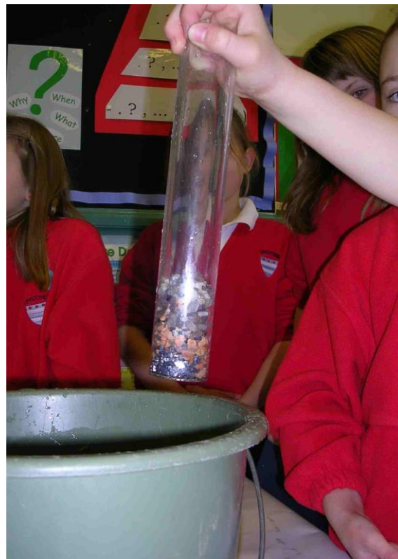
Um agitador sendo usado para separar galena, barita, fluorita e calcita de uma amostra triturada
