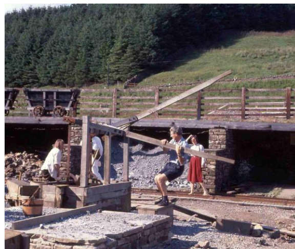
A reconstrução em tamanho real de um agitador no chão coberto de minérios no Museu Kilhope Mining, County Durham
