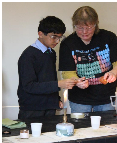
Passo 2 - mergulhando a vareta de carvão vegetal no pó de óxido de ferro
