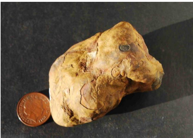
Fotografia 2: Um nódulo de minério de ferro retirado de uma camada plana com outros nódulos como esse (Moeda de 2 centímetros) [Pot Clay, Carboniferous, near Sheffield, Inglaterra]
