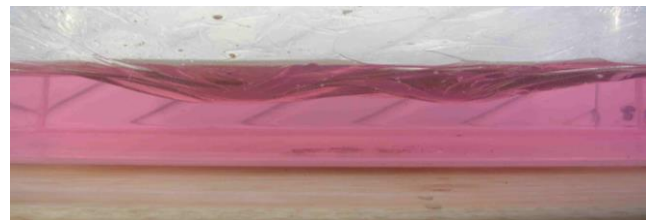
Fotografia 7: Estruturas de carga formadas quando a areia pressiona a película aderente (vista lateral).
