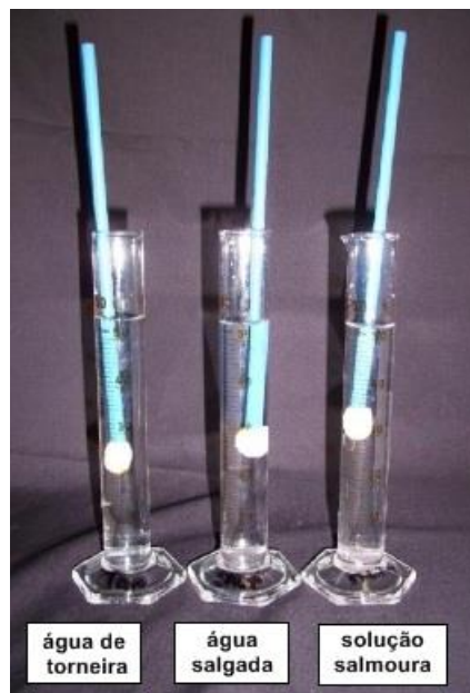
Um “testador de salinidade” flutuando na água em diferentes. (Fotografia: S Allen e G Jones).
