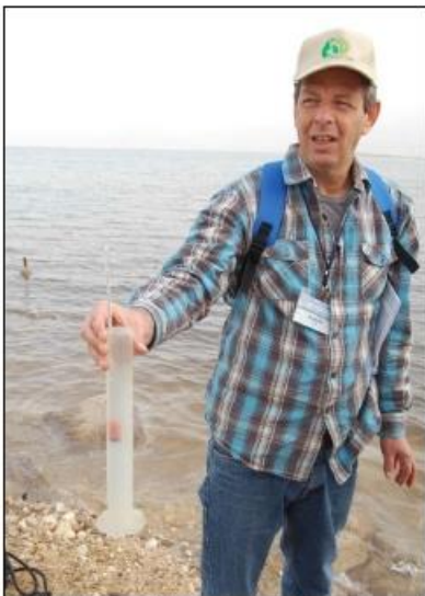
Um cientista medindo a densidade da água salgada do Mar Morto para descobrir quanta evaporação é necessária antes que o sal cristalize da solução. (Fotografia: Chris King)
