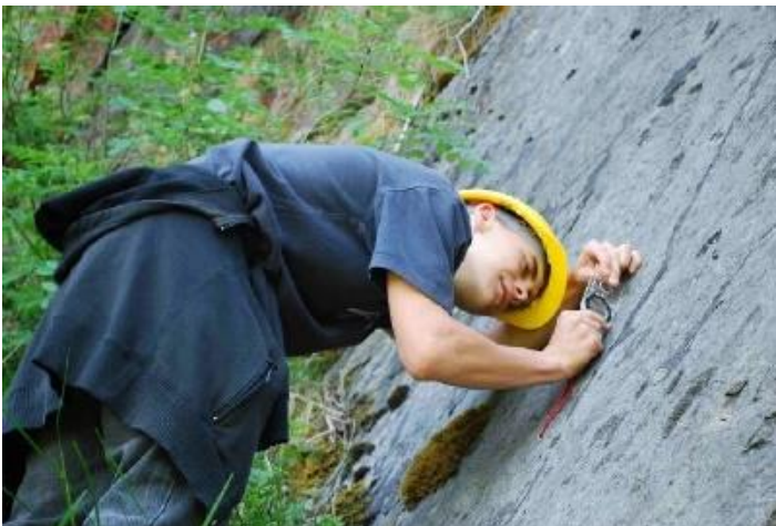
Medindo o ângulo de inclinação em rochas inclinadas. (Peter Kennett).
