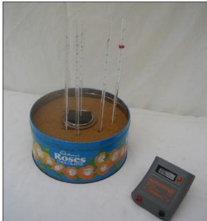
Aparato montado para medir as velocidades de resfriamento ao redor de uma "intrusão" de água quente na areia utilizando uma lata de metal com tampa no centro e cinco termômetros. (Mike Tuke).
