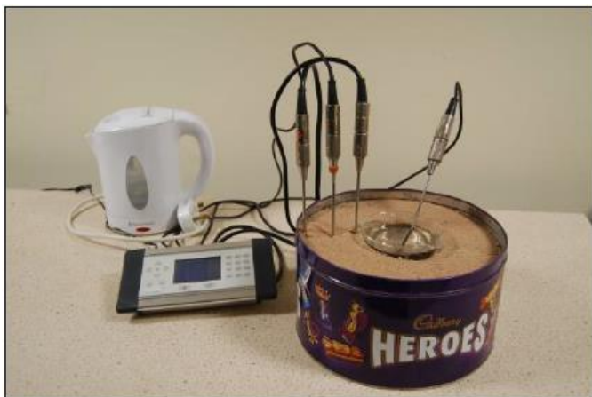
Aparato montado para medir as velocidades de resfriamento ao redor de uma "intrusão" de água quente na areia utilizando um béquer de vidro no centro e um registrador de dados com 4 sondas. (Chris King).
