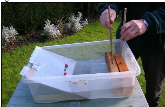
Foto 2: Simulando uma falha de gravidade, deslizando um bloco contra o outro.
