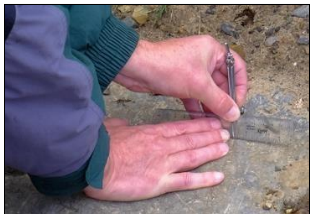
O método sendo demonstrado utilizando um par de compassos e uma régua para medir a profundidade dos estriamentos glaciais, Traeth Bychan, Anglesey, Reino Unido. (Peter and Maggie Williams).
