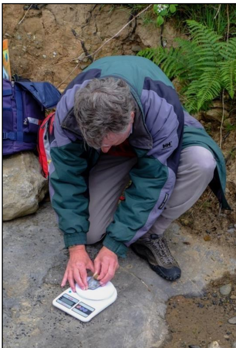
Utilizando uma balança eletrônica para medir a força necessária para arrancar um seixo de calcário com um fragmento pontiagudo de till . Traeth Bychan, Anglesey, Reino Unido. (Peter Williams).
