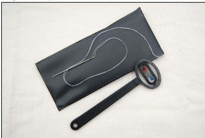
Um "magnetômetro" Magnaprobe™ ou agulha magnetizada em uma linha.
