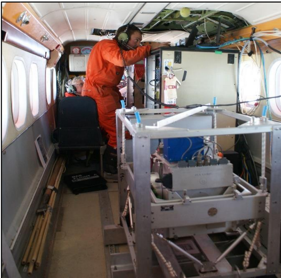
Gravímetro em uma aeronave da British Arctic Survey.
