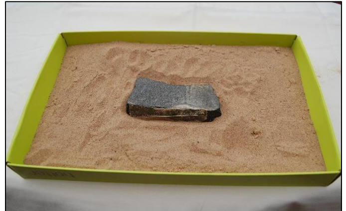
Uma rocha densa (pedaço de gabro) enterrada em uma 'rocha' menos densa (areia solta) com uma agulha magnetizada presa a ela. Na prática, a rocha é enterrada de modo que apenas sua superfície superior seja visível.
