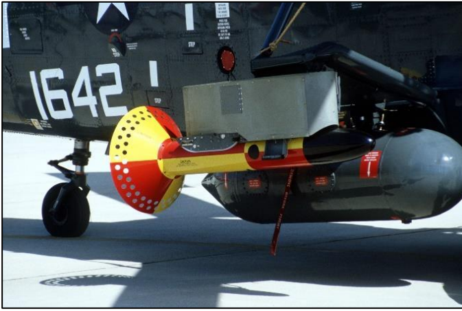
Detector aéreo de anomalias magnéticas em helicóptero da marinha norte-americana
