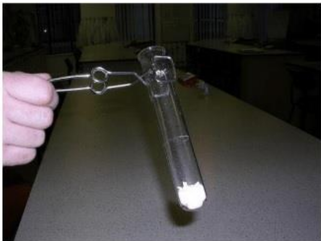
Aquecendo a gipsita moída em um tubo de ebulição Pyrex (TM) , com gotículas de água condensando próximo ao topo do tubo. (A chama Bunsen é invisível nesta fotografia). (Foto: P. Kennett)
