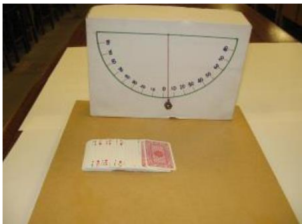
Figura 7b. Modelando falhas em rochas incompetentes – deslizamento.
