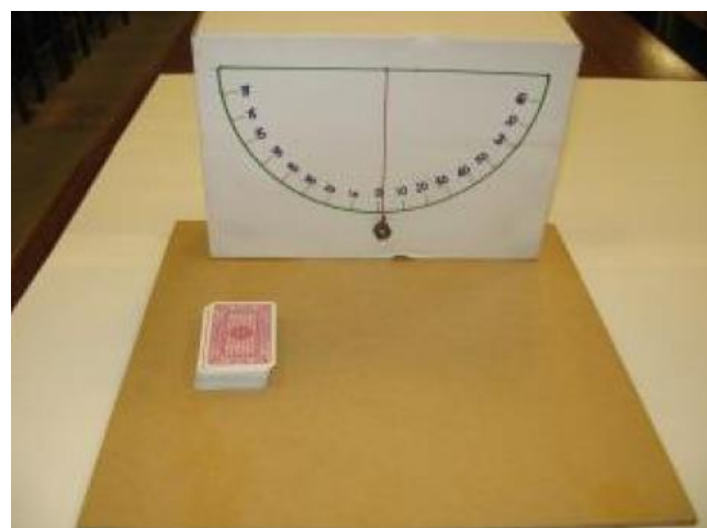
Figura 7a. Modelando falhas em rochas incompetentes – deslizamento.
