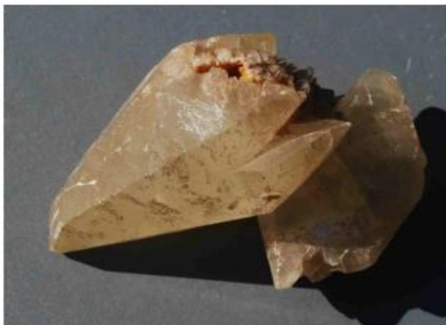
Dois minerais com faces bem definidas 1) calcita, \text{CaCO}_3
