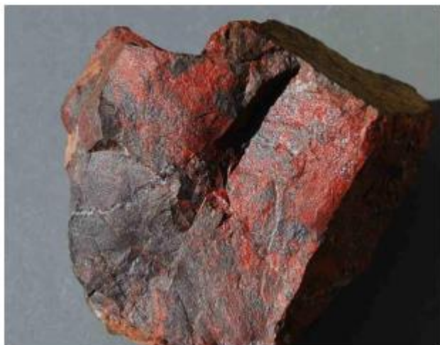
Dois minerais com faces de cristal com faces pouco definidas 3) hematita \text{Fe}_2\text{O}_3
