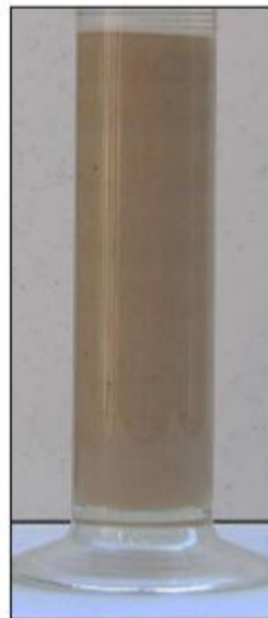
Vários leitos de sedimentos em um cilindro de medição, mas os planos do leito não podem ser vistos porque a areia é da mesma cor. (Chris King)
