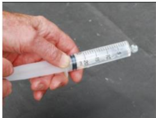
A água na seringa começa a ferver e a produzir bolhas de vapor de água à medida que a pressão é reduzida puxando o êmbolo para trás.
