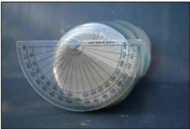
Testando o ângulo do resto da areia seca, como em dunas do deserto.
