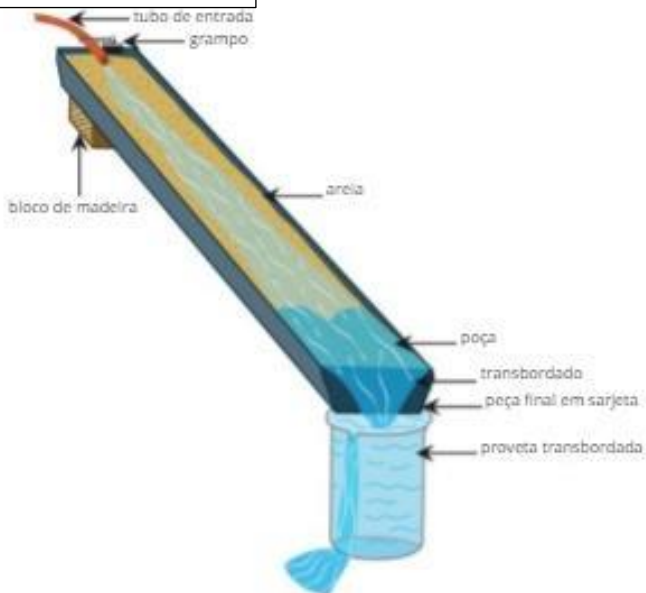
Estratificação cruzada - a instalação da calha (Unidade de geociência)
