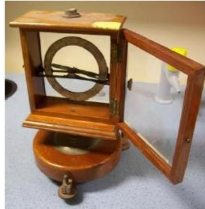
Uma agulha magnética, com o ponteiro magnético que gira no plano vertical para mostrar a inclinação do magnetismo da Terra. (Fotografia: Suzy Allen/Gwyn Jones)
