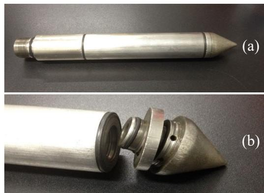
Figura 1. Exemplo de ponteira utilizada no ensaio CPTu (a) e detalhe da posição de leitura das pressões neutras logo acima da ponta (b)
