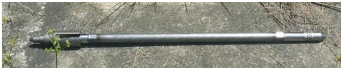
Figura 2. . Sonda DPIL. Janela de injeção indicada. Modificado de Vianna et al. (2016)
