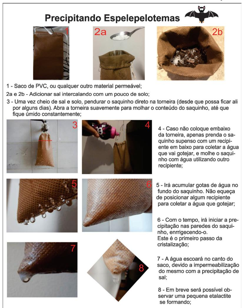
Figura 3. Procedimento ilustrativo do experimento, utilizando sal grosso para churrasco. Para mais detalhes consultar texto de Materiais e Métodos
